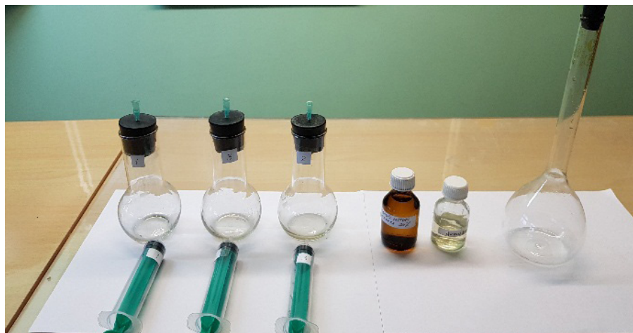
Рисунок 1 – Прибор и реактив для поглощения углекислого газа
