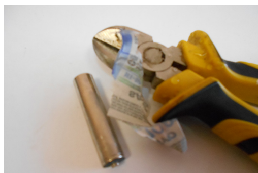
Рисунок 2 – Извлечение цинка и угольных электродов
